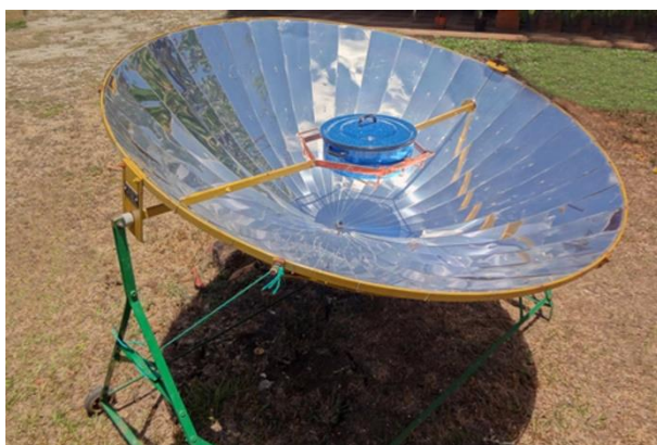
Сл. 2.12. Параболична соларна пећница са посудом за спремање јела (Eco-Business 2021) Fig. 2.12. Parabolic solar oven with cooking utensil (Eco-Business 2021)
