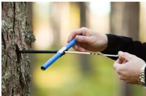
Сл. 12.3. Узимање узорка прираштајним сврдлом (Фото Ивановић Р 2013) Fig. 12.3. Sampling using incremental drill (Photo Ivanović R 2013)
