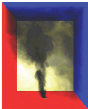
Figur 3. Røgbevægelse i et atrium med begrænsningsflader med forskellige temperaturer.
