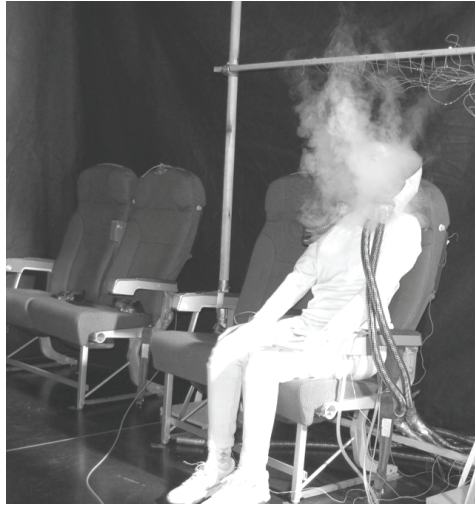
Figur 3. Flystol med en nakkestøtte der forsynes med luft fra et PV system. Røgen markerer den rene luft, der tilføres til mannequinens åndingszone.
