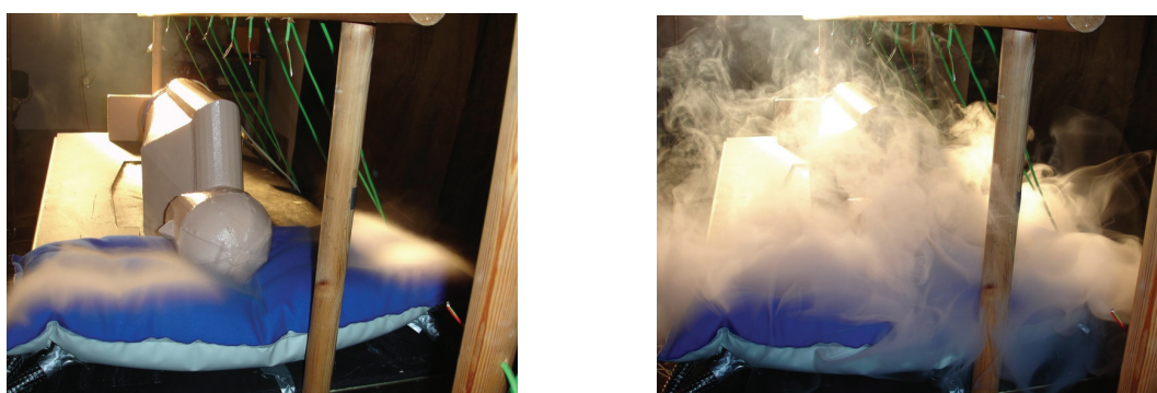
Figur 2. Strømning af luft fra en ventilationspude som for eksempel kan anvendes i et hospitalsmiljø.
