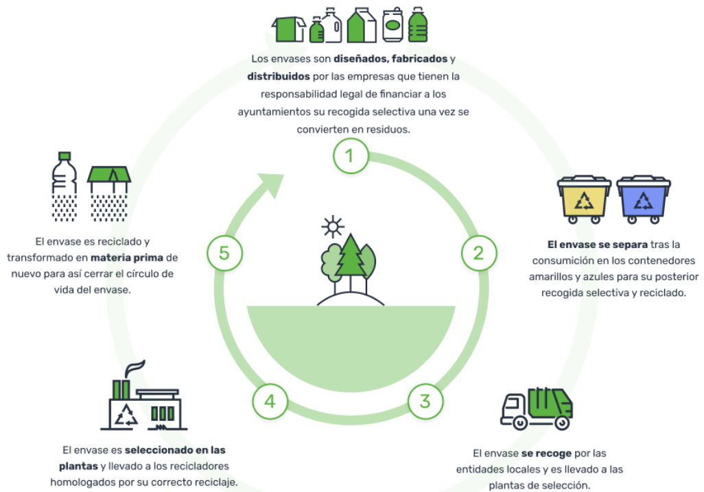
Ilustración 29. Proceso de reciclaje de envases Fuente: Ecoembes
