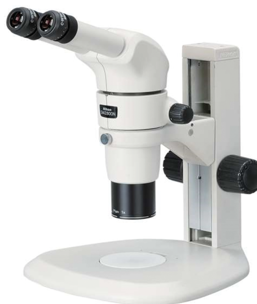
Figura 3.- Microscopio estereoscopio (oculares 10X, objetivo 1X con zoom continuo)
