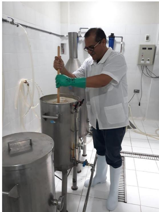
*Figura 16.* Homogenización en la maceración
