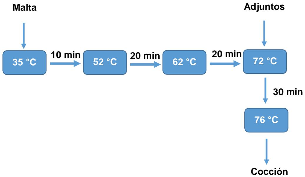
*Figura 15.* Esquema de maceración escalonada
