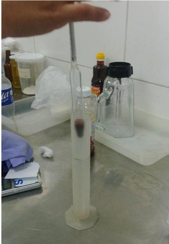
*Figura 20.* Medición del grado alcohólico
