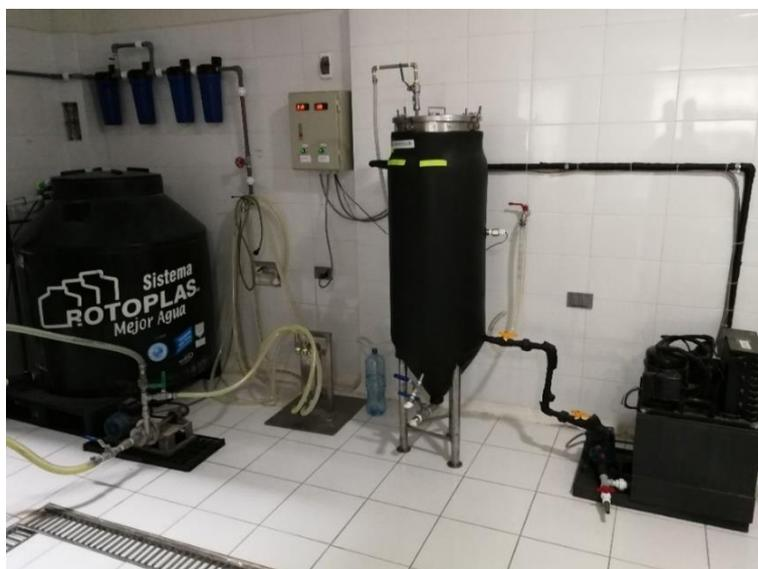
*Figura 13.* Equipos del sistema de producción de cerveza artesanal II. De izquierda a derecha: tanque de agua y filtros, fermentador y chiller
