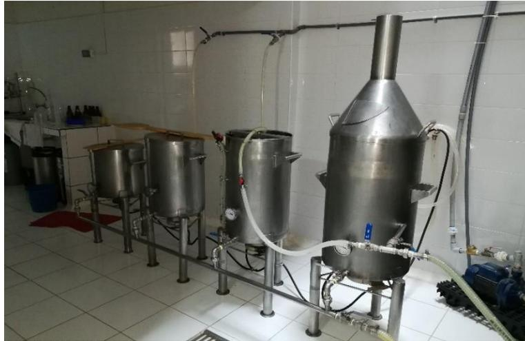
*Figura 12.* Equipos del sistema de producción de cerveza artesanal I. De izquierda a derecha: hervidores de 30 y 50 L, macerador y Whirlpool
