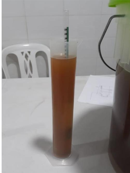
*Figura 17.* Medición de la densidad
