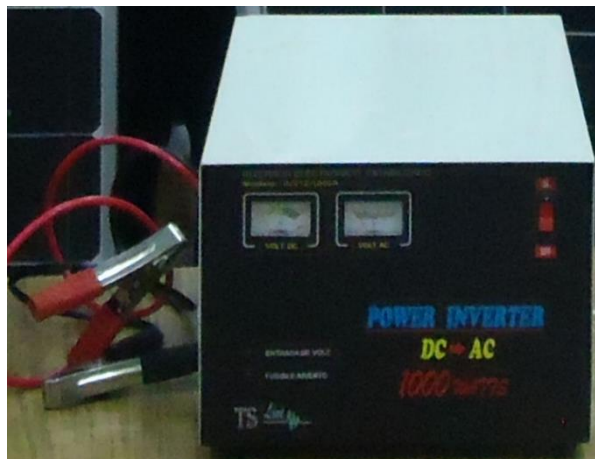
Figura 5: Convertidor o inversor de carga
