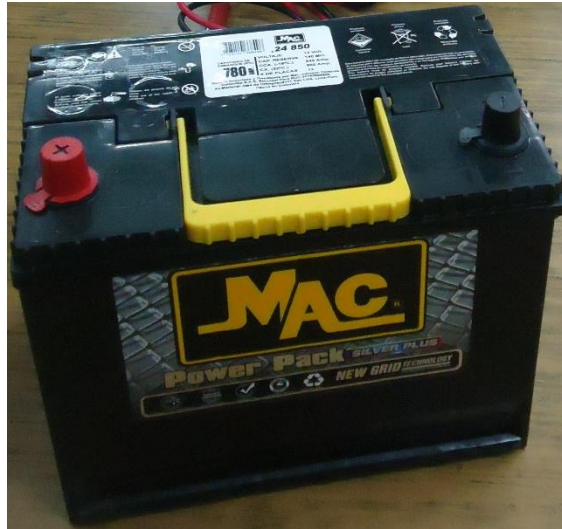
Figura 4: Acumulador o batería
