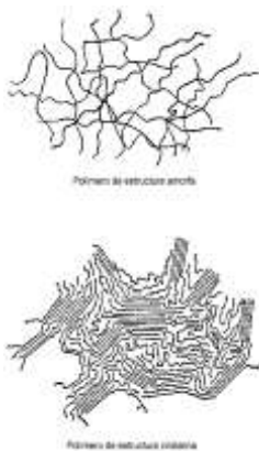
Figura 8 Zonas cristalinas y amorfas de la celulosa
