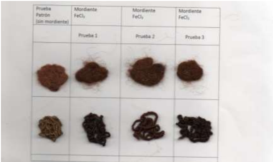
Figura 25. Carta de colores comparativos obtenidos en las pruebas de teñido de lana de oveja y de fibra de lana de oveja (Mordiente: \text{FeCl}_3 )
