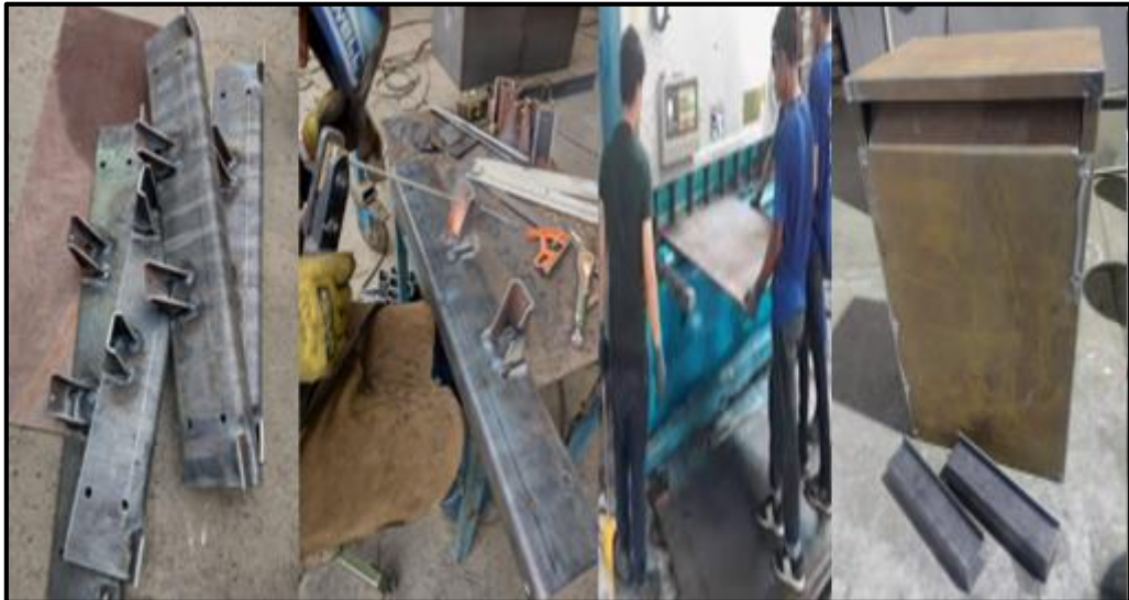
Figura 29. Proceso de fabricación de bridas y caja de protección
