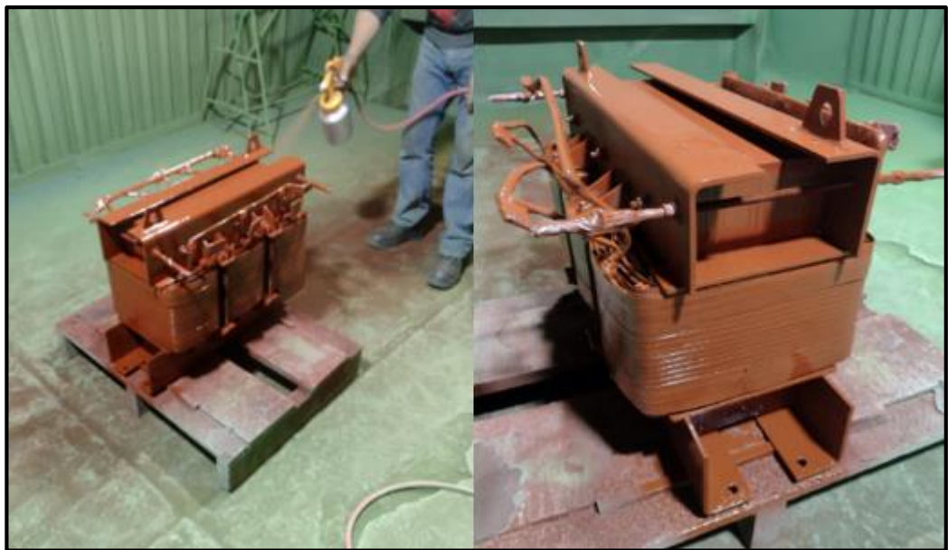
Figura 33. Barnizado de la parte activa
