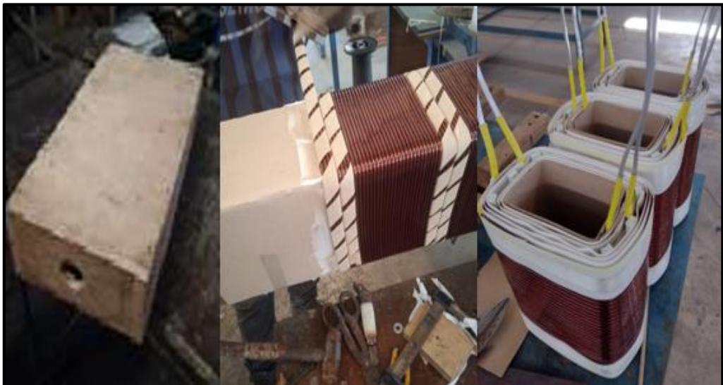
Figura 28. Proceso de bobinado primario y secundario
