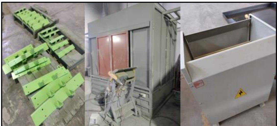
Figura 30. Proceso de pintado de bridas y caja de protección
