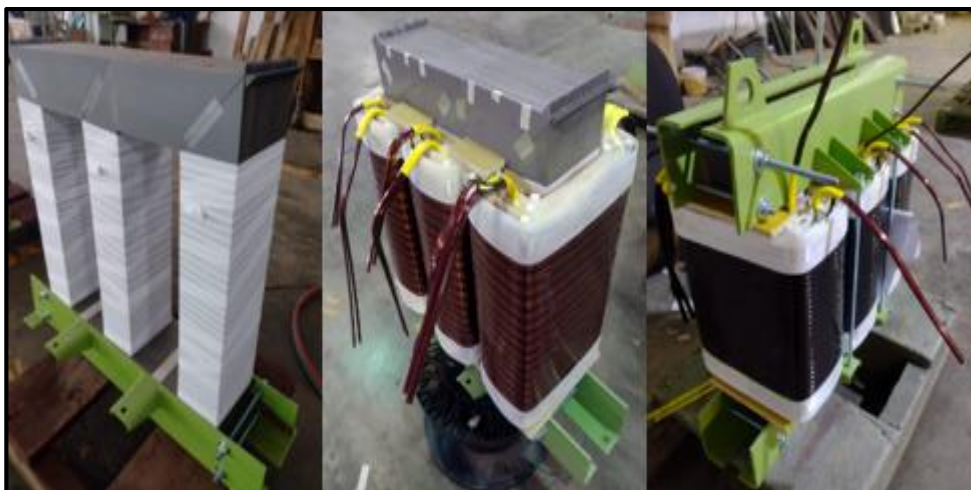
Figura 31. Proceso de ensamblado de la parte activa
