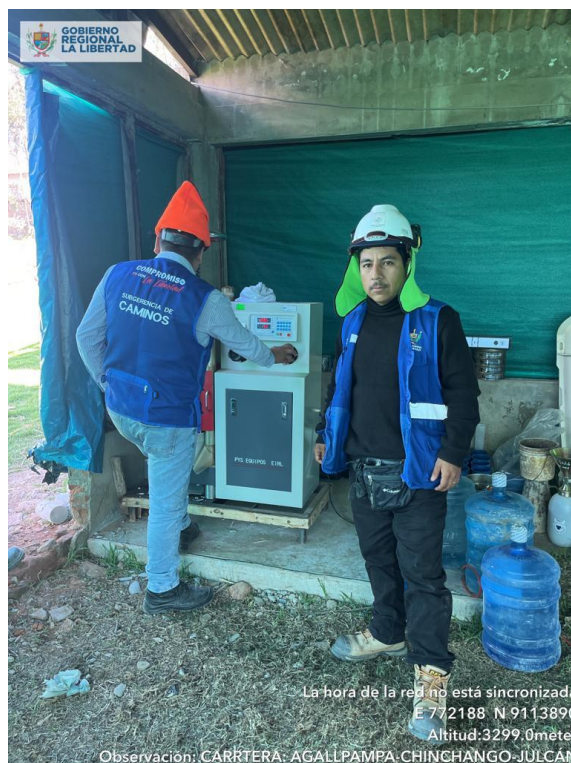
Fotografía N° 01: Rotura de probetas
