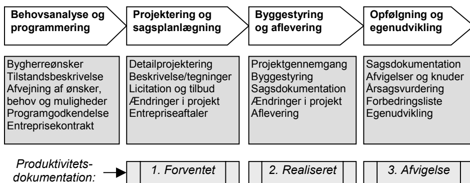
Figur 1. Uddrag af rådgiverens forskellige opgaver i de enkelte faser af en renoveringssag set i forhold til den udførte dokumentation af produktivitet. Det er disse opgaver, der skal fokuseres på i rådgiverens egenudvikling.
