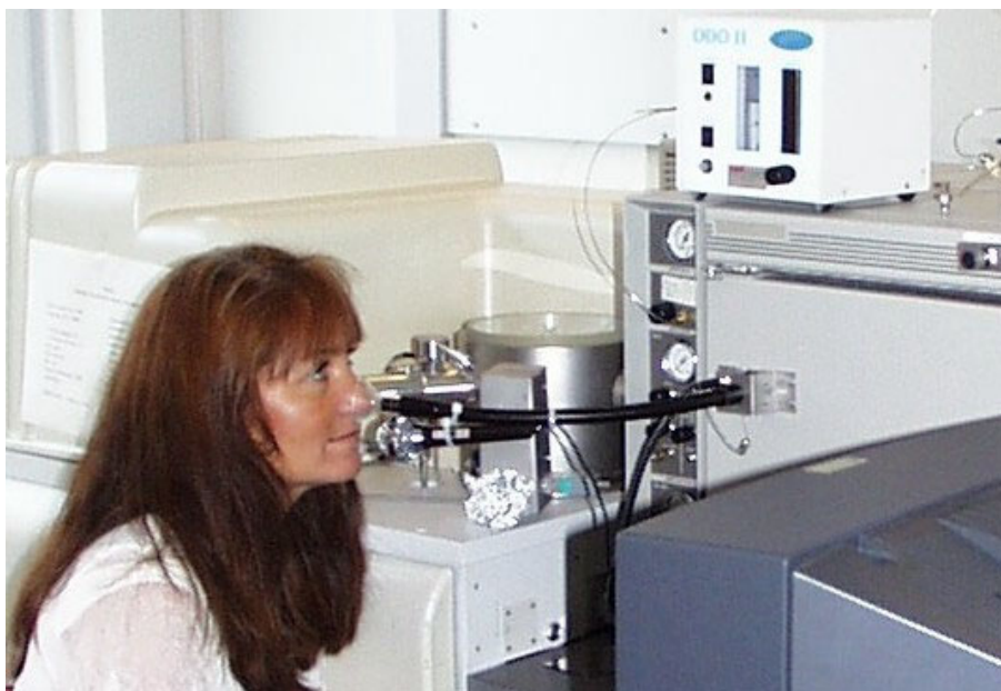
Figur 3. Foto af GC-O-apparatur og GC-O-panelist. Mikrofonen på næsetragten blev brugt til at optage kommentarer fra panelisten under chromatograferingen på videotape, hvor de tilhørende og samtidige billeder viste chromatogrammet fra massespektrometret.
