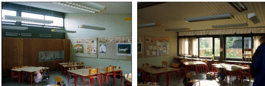
Figur 32. Højsiddende dagslysvinduer og udsigtvinduer i klasseværelse på Sønderbro skole, København. Det diagonale lysindfald bevirker, at der kun er få steder i lokalet, som ikke modtager dagslys.
