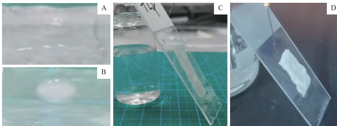
图7 血管内膜表面疏水性的结果
