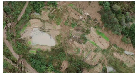
图13 滑坡期间地表积水洼地
