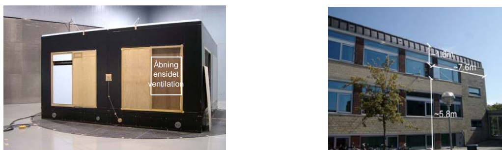
Figur 2. Forsøgsbygningen i vindtunnelen (5,6x5,6x3m) (til venstre) og kontorbygningen brugt til udendørs forsøg (til højre).
