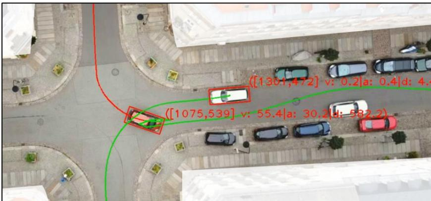
Abb. 1: Videobasierte Analyse der Fahrwege
