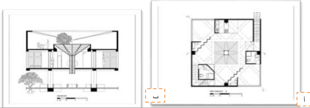
شكل (٢، أ، ب) المخطط الأفقي للطوابق والمقطع العمودي للفضاء الحواري في الفيلا. (المصدر-السابق).
