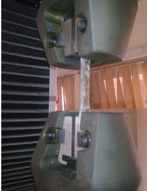
Figure (1) Tensile test apparatus
