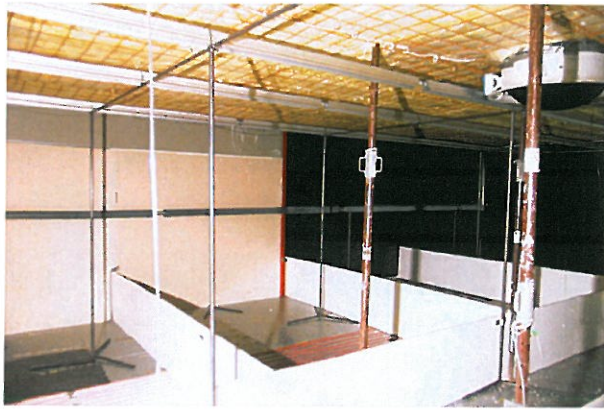
Figur 1. Billede af forsøgsopstillingsrummet. Røde varmekabler placeret på gulvet langs midteraksen simulerer varmeafgivelse fra dyrene. Rørformet centralvarmeanhed er placeret ved væggen 1,2 m over gulvet. Udsugning i øverste højre hjørne.
