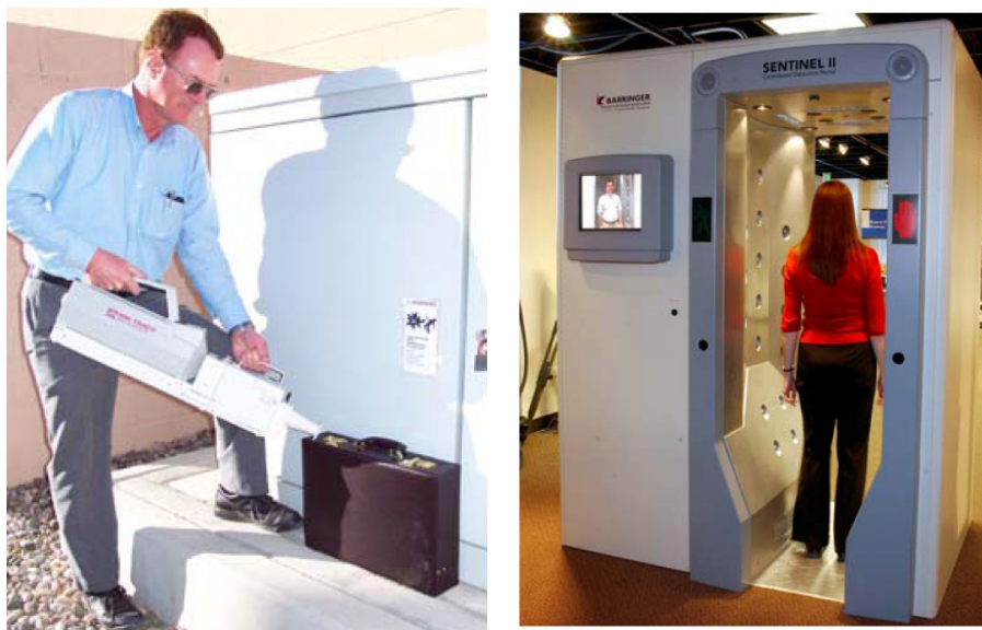
Figura 3 : Analizadores IMS para detección de drogas tipo portátil (izq.) y portal para control de drogas y/o explosivos en aeropuertos o embajadas (der.) . Fotos :Sandia National Labs.
