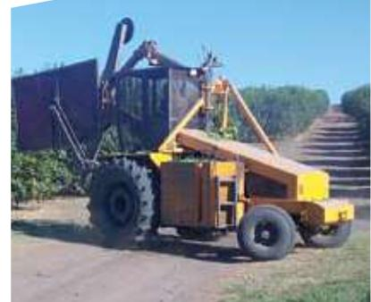
**Figura 2.** Podadora a discos giratorios de un eje rotativo.
