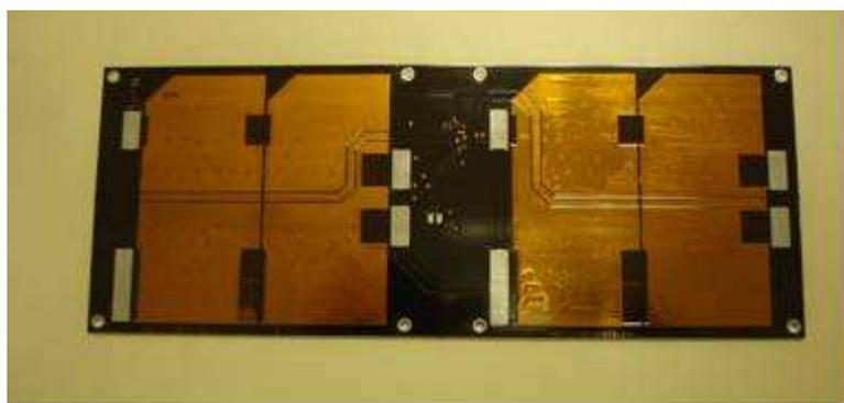
Figura 1: Sustrato de fibra de vidrio con pistas de cobre para la interconexión de las celdas.
