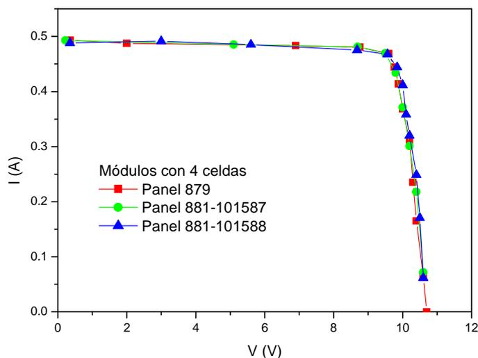
Figura 3: Curvas IV de los sustratos con 4 celdas
