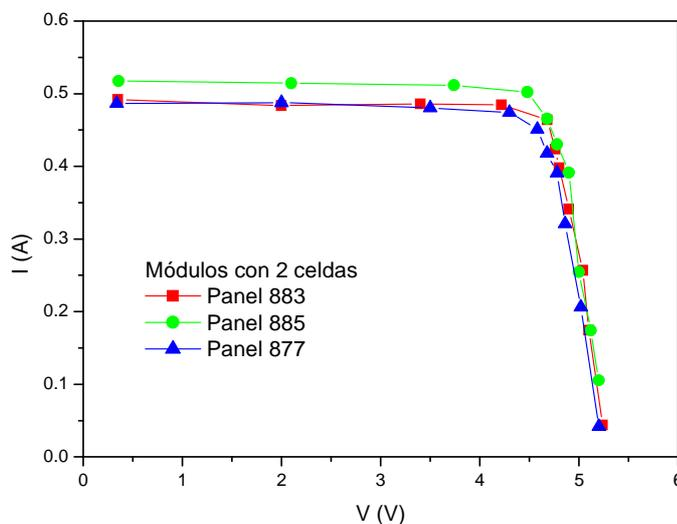
Figura 3: Curvas IV de los sustratos con 2 celdas
