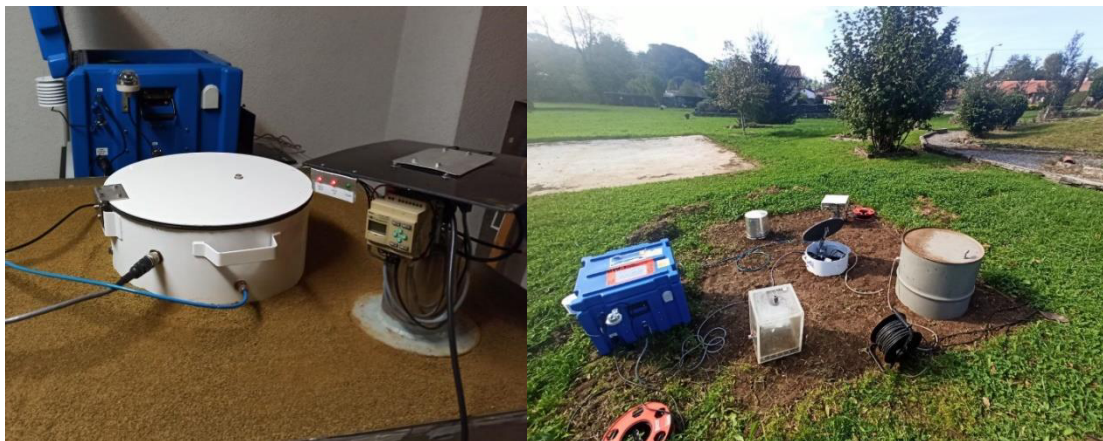
Slika 6: (leva strana) Etaloniranje sistema za merenje fluksa radona [23], (desna strana): jedna od interkomparacija dostupnih sistema za merenje fluksa [24]
