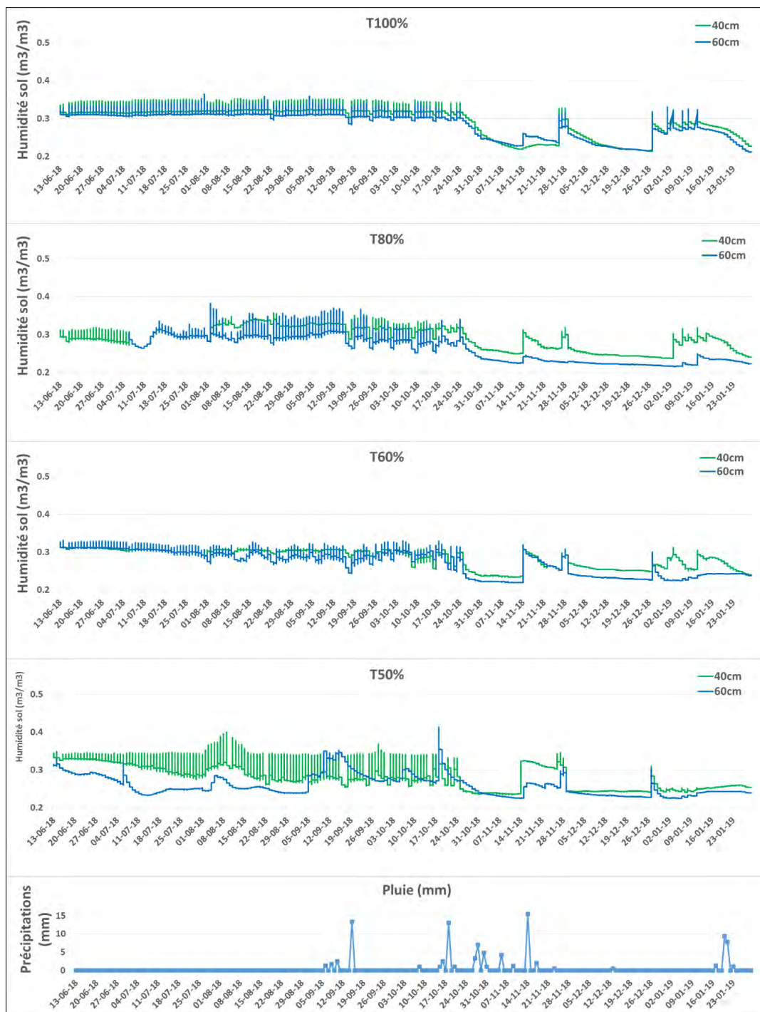
Figure 10. Évolution de l’humidité du sol dans les horizons 40 cm et 60cm près du goutteur pour les quatre traitements T100%, T80%, T60% et T50% pendant la période entre juin 2018 et janvier 2019 . Le dernier graphe montre les précipitations pendant la même période.
