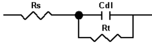
Figure 5. Circuit électrique équivalent de l'interface métal/électrolyte R_s : résistance de l'électrolyte, R_t : résistance de la double couche, C_{dl} : capacité de la double couche.
