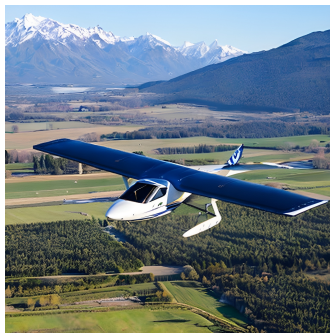
Figura III.1 Ejemplo de UAV de ala fija. Estos sistemas presentan una estructura formada por dos o más alas que no son móviles y que, además, su vuelo es similar al de un avión tradicional (Beard et al. 2014).
