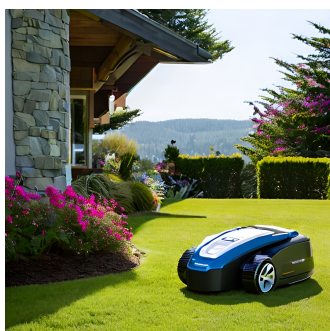
Figura III.3 UGV cortacésped doméstico. Los UGV se caracterizan por estar limitados a la topología del terreno, por lo que tienen una reducida libertad de movimiento pero con gran capacidad de adaptabilidad a las necesidades de la operación (Gage 1995).
