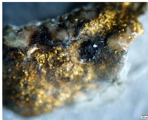
Figura 36 – Superfície da amostra nº 10 (fator de ampliação 100X). ©Lab IPT.
