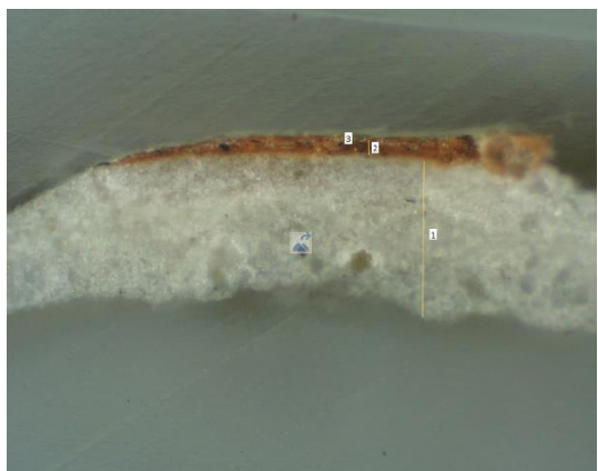
Figura 33 – Corte estratigráfico da amostra nº 9 (fator de ampliação 100X). ©Lab IPT.
