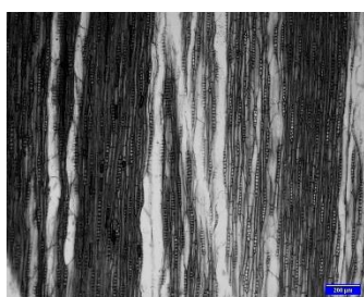
Figura 7 - Imagem obtida ao microscópio em luz transmitida: Corte tangencial (fator de ampliação:40x) (©Lab IPT).
