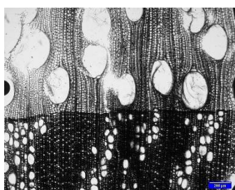
Figura 6 – Imagem obtida ao microscópio em luz transmitida: Corte transversal. (fator de ampliação:40x) (©Lab IPT).
