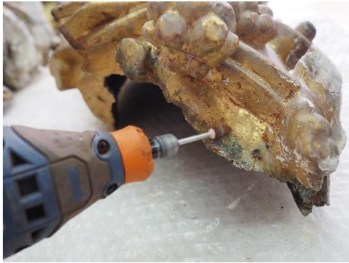
Figura 75 – Remoção de ferrugem com um mini berbequim com esmeril.
