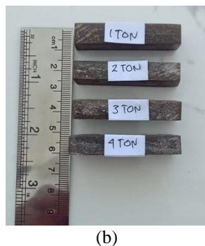
Gambar 1. (a) Spesimen uji kekerasan sesuai standar ASTM D 2240 (b) Spesimen hasil variasi pembebanan kompaksi
