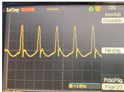
Figura 3: Lectura de una presión en función de la conversión voltaica promedio en 140 psi a 300 msnm
