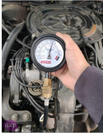
Figura 2: Lectura en el compresómetro de 132 psi a 300 msnm
