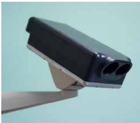
Рис. 10. Датчик состояния поверхности дорожного полотна.
