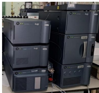
Figura 9. Equipo de cromatografía líquida de ultra-eficacia con detección de cuadrupolo (UHPLC-QDa) empleado para la identificación de los compuestos fenólicos.
