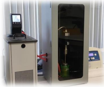
Figura 8. Equipo para la extracción asistida por ultrasonidos (UAE).
