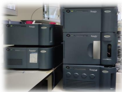
Figura 11. Equipo de cromatografía UHPLC-DAD empleado para la cuantificación de los compuestos fenólicos en los espárragos.
