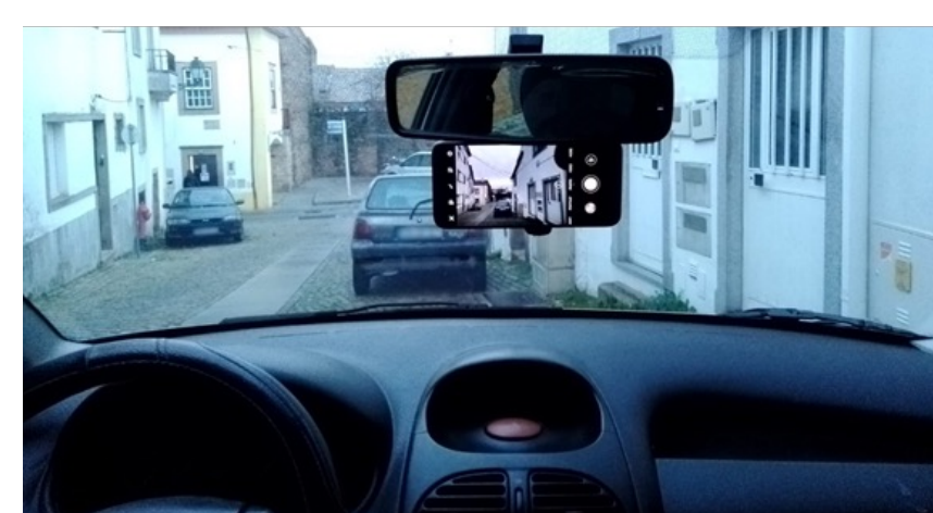
Figura 2 – Setup telemóvel para captura de imagens.
