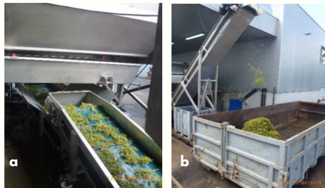
Figura 5 - a) Transporte do engaço após o desengaçamento; b) recolha do engaço com as películas e as grainhas no mesmo contentor.
