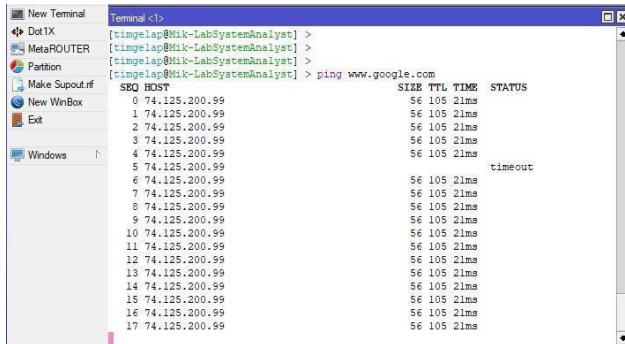
Gambar 7. 14 Proses PING dari Router ke Google
