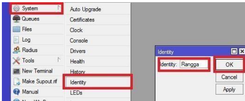
Gambar 7. 4 Langkah untuk mengubah nama Router
