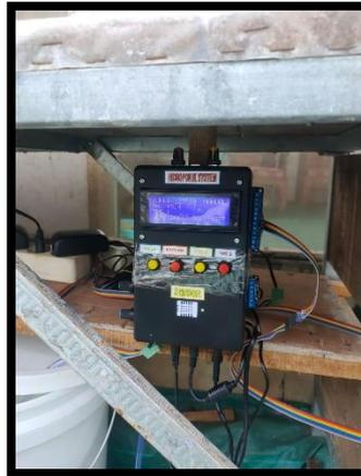
Gambar 1. Alat Pengontrol pH dan Nutrisi
