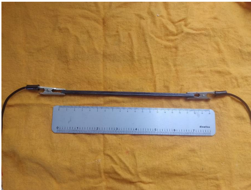
Figura 2. Configuração com as duas barras de resistência de grafite em paralelo, aumentando a área de secção transversal.
