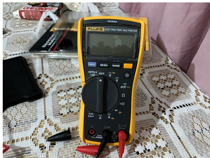
Figura 6. Aparelho Multímetro utilizado na função Ohmímetro para medir a resistência do material.
