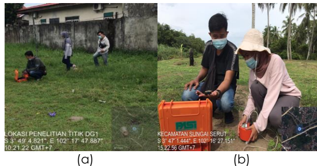
Gambar 8. Proses pengukuran gelombang mikro di lapangan (a) penentuan lokasi pengukuran, (b) perekaman gelombang mikro
