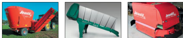
Рис. 2. Технические устройства для реализации Системы (слева направо): мобильный смеситель-раздатчик кормов с дополнительным транспортером; бункер-накопитель; колесный роботизированный кормораздатчик
