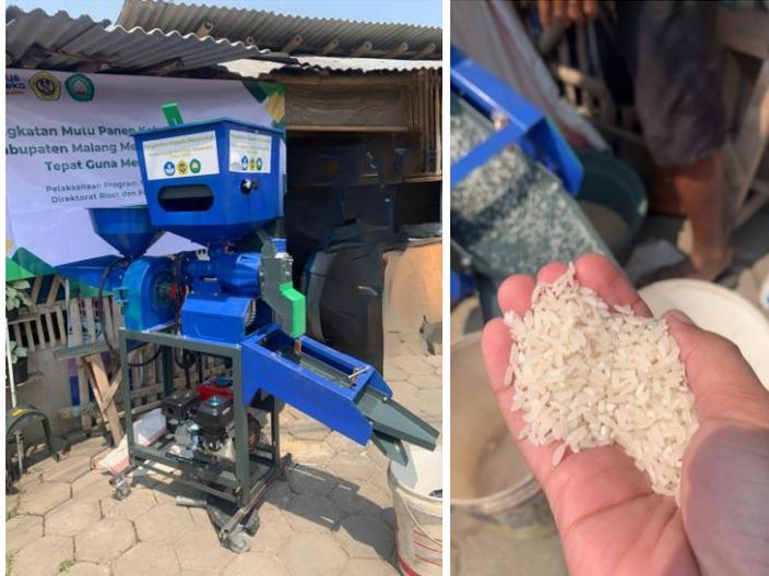
**Gambar 6.** Mesin selep padi 2 in 1 dan beras hasil selepan
