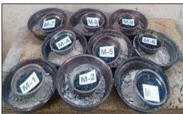
Figura 6: Especímenes de agregado y material reciclado aptas para abrasarse en el horno.
