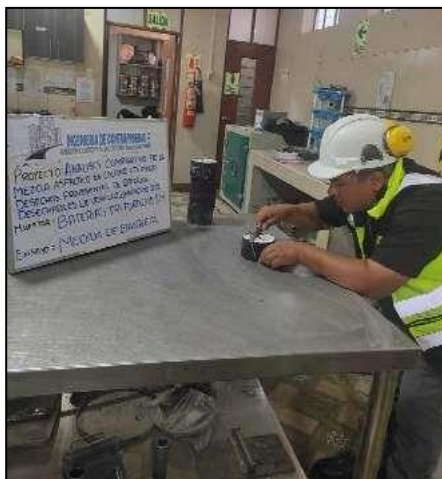
Fotografía N° 25: Realizando las medidas correspondientes a cada espécimen con adición de desechos de baterías al 10%, conforme a la norma MTC E-507.
