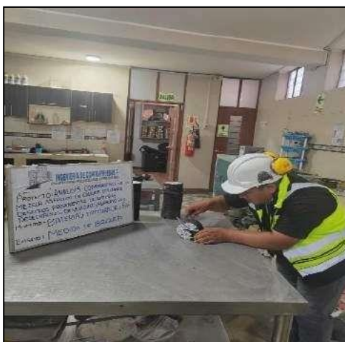
Fotografía N° 24. Realizando las medidas correspondientes a cada espécimen con adición de desechos de baterías al 8%, de acuerdo a la norma MTC E-507.
