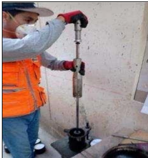
Figura 8: Compresión de mezcla asfáltica en caliente
