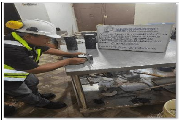
Fotografía N° 7. Realizando las medidas correspondientes a cada espécimen, según la norma MTC E-507
