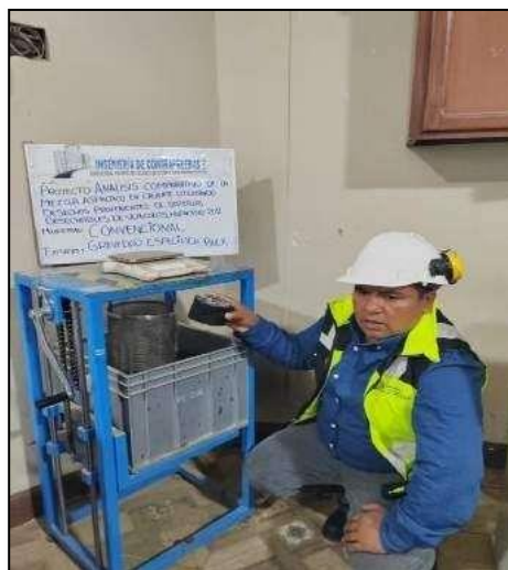
Fotografía N° 8. Se registra dos masas al espécimen tanto, en el aire y en el agua (en ese orden), dentro de una canastilla sumergida en agua a 25 \pm 1^\circ \text{C} ( 77 \pm 1.8^\circ \text{F} ), luego con el apoyo de un paño absorbente se debería secar y llegara un estado saturado superficialmente seco (SSS) para poder determinar la gravedad específica bulk.
