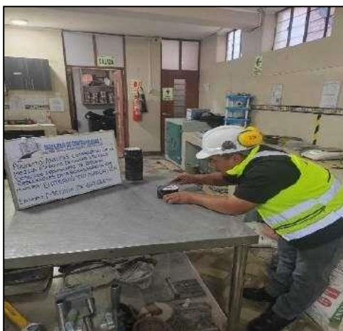
Fotografía N° 26. Realizando las medidas correspondientes a cada espécimen con adición de desechos de baterías al 12%, de acuerdo con la norma MTC E-507.
