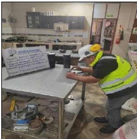
Fotografía N° 23. Realizando las medidas correspondientes a cada espécimen con adición de desechos de baterías al 6%, de acuerdo a la norma MTC E-507.
