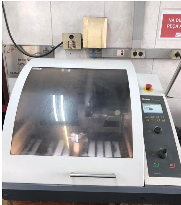
*Figura 18 – Máquina de corte a disco*
