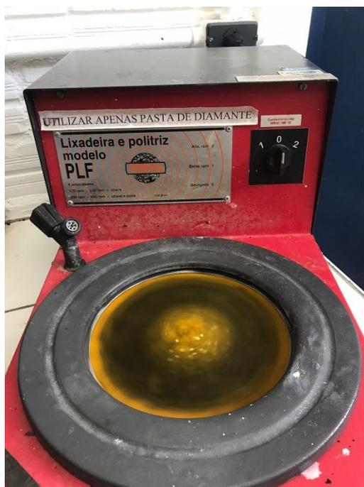
Figura 16 - Politriz utilizada no processo de polimento do material.
