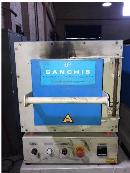
Figura 14 - Forno para aquecimento dos materiais de forjamento
