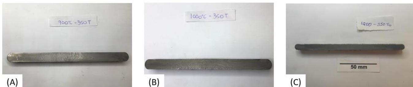
Figura 30 – Macrografia “billets” em carga de compressão de 350 toneladas nas temperaturas (a) 900°C (b) 1000°C (c) 1200°C.
