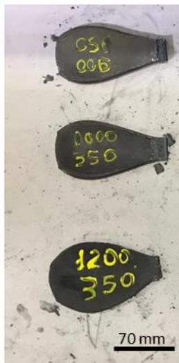
Figura 26 - Cunhas após o ensaio de forjamento, as temperaturas de processamento e cargas aplicadas estão indicados nas cunhas
