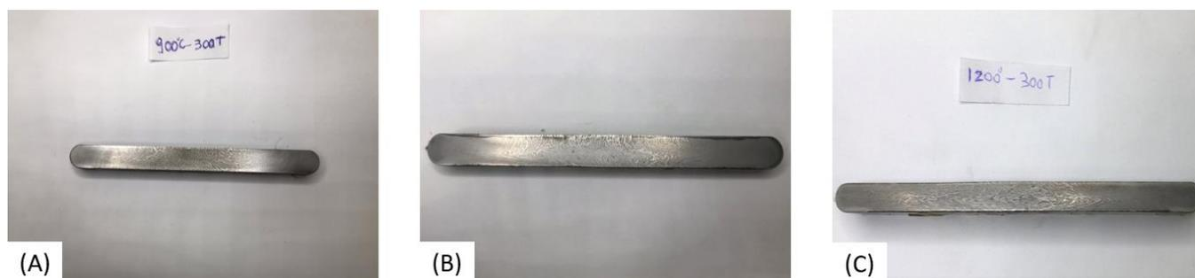
Figura 31 – Macrografia “billets” em carga de compressão de 300 toneladas nas temperaturas (a) 900°C (b) 1000°C (c) 1200°C.
