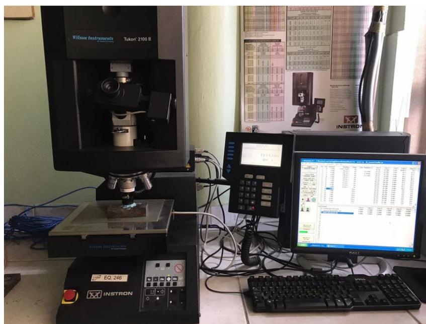
*Figura 23 – Microdurômetro utilizado para perfil de microdureza.*
