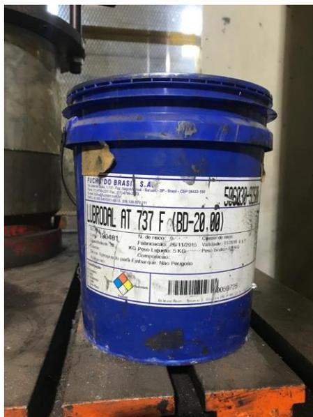
Figura 13 - Lubrificante aplicado no processo de forjamento – Lubrodal AT 737F da Fuchs do Brasil.
