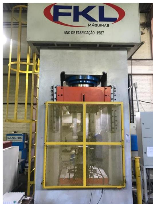
Figura 10 - Prensa hidráulica de 780 toneladas, marca FKL
