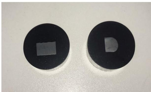
*Figura 21 - Amostras preparadas para ensaio microscópico*
