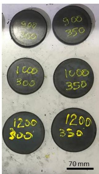
Figura 25 - Aspectos dos “billets” após o processo de reclaque, os parâmetros de processamento estão indicados nos “billets”.
