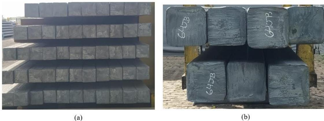
Figura 15 – Exemplo de tarugos produzido a partir de (a) seção de molde 155 mm e (b) seção de molde 240 mm. Fonte: o autor.
