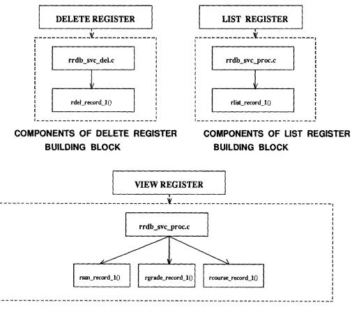
COMPONENTS OF VIEW REGISTER BUILDING BLOCK
