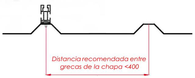
**⚠ Espesor mínimo de la chapa 0.5 mm**
