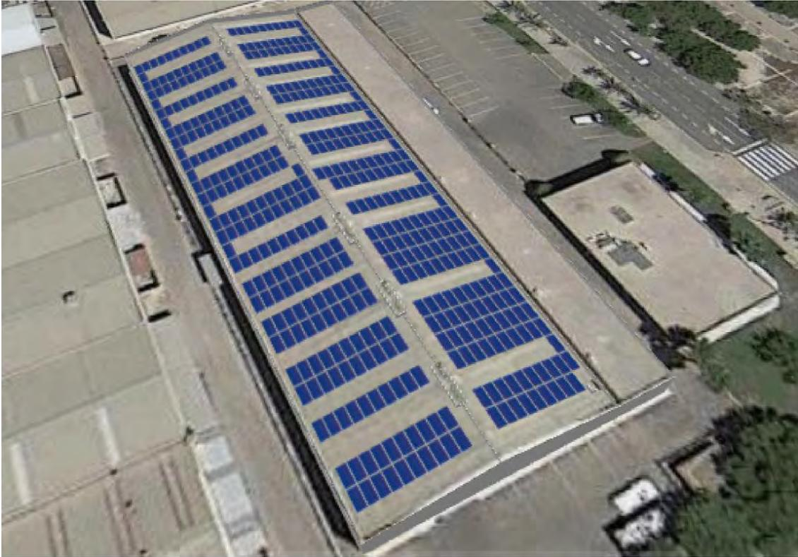
Figura 11: Diseño 3D y distribución de módulos SolarEdge Designer.
