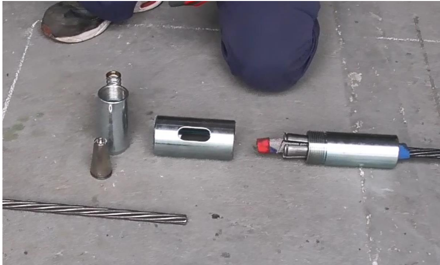
Figura 3.4.1.5 Material usado para la conexión de los cables CFRP con los tendones de acero
