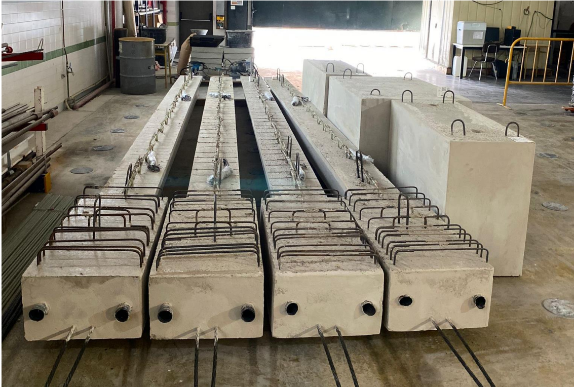
Figura 3.7.6 Vigas pretensadas con CFCC en las instalaciones de la universidad
