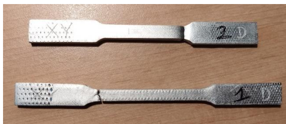
figura 31: Provetes trencades en XY una vegada fet l'assaig. Font: Pròpia
