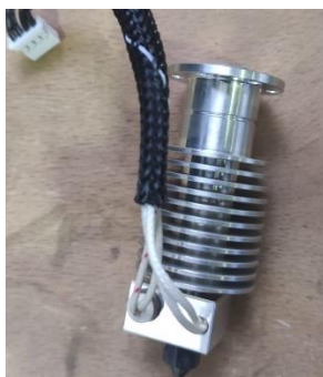
figura 14: Hotend utilitzat amb la Epsilon W27. Font: Pròpia
