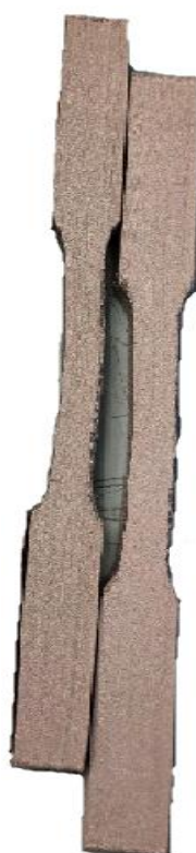
figura 32: Provetes sinteritzades en el pla ZX. Font: Pròpia
