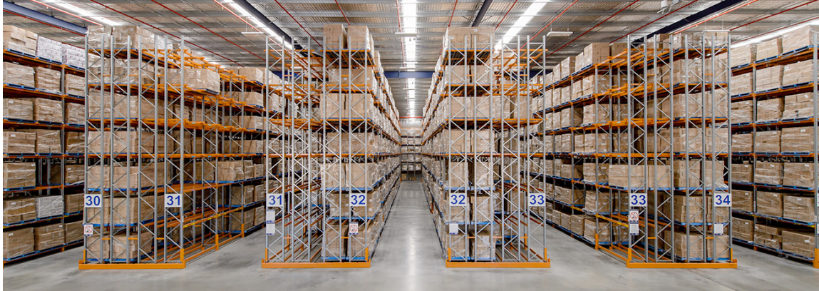
Figura 4. Estanterías de doble profundidad (Fuente: RackingSystem)
