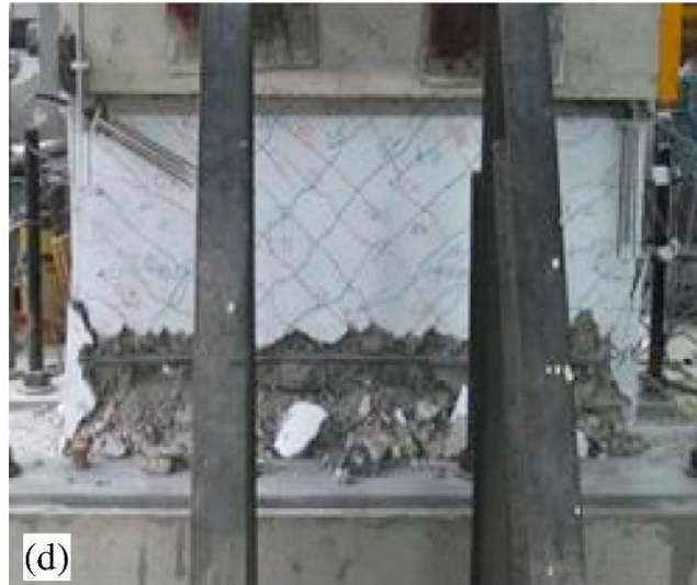
Figure 7. Diagonal compression (d) T2-S. Source: Terzioglu et al. (2018).
