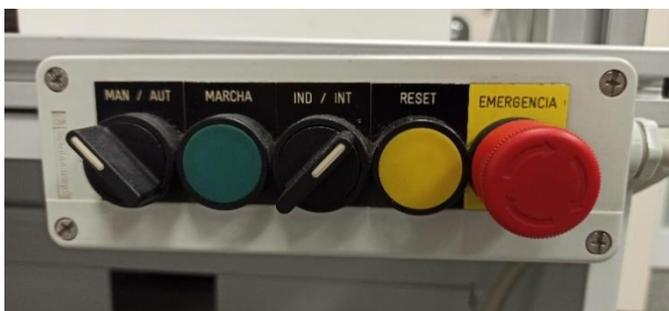
Figura 21. Botonera estación robótica.
