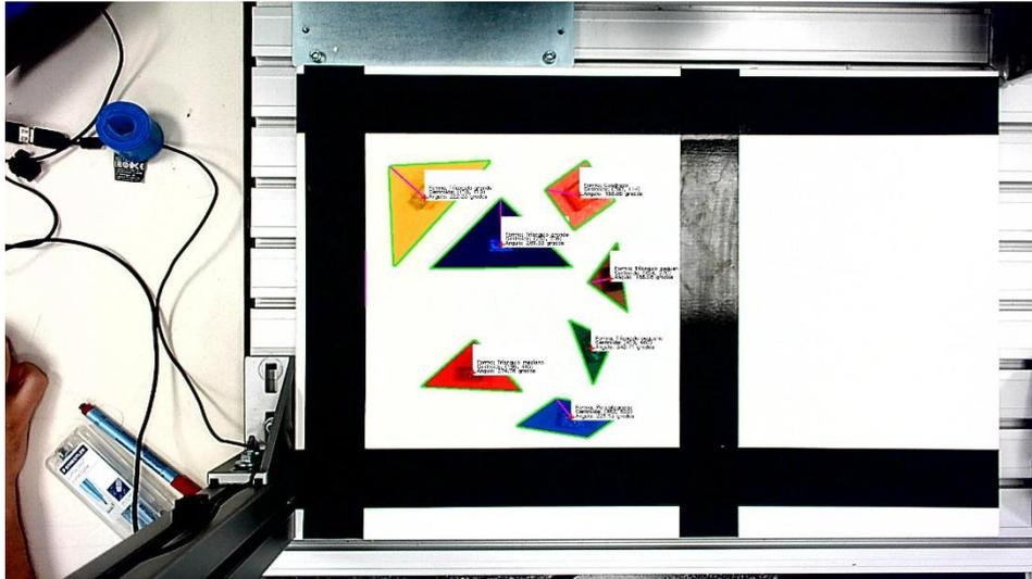
Figura 80. Quintas pruebas visión por ordenador, captura original con detecciones.
