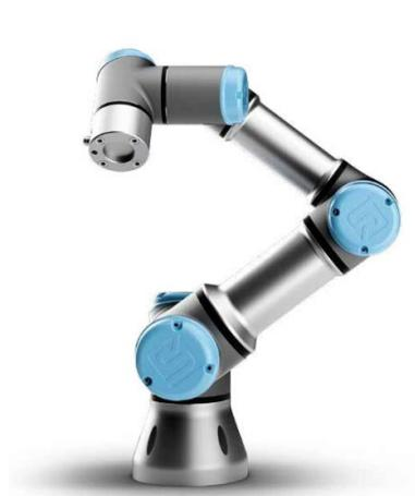
Figura 15. Brazo robótico UR3
