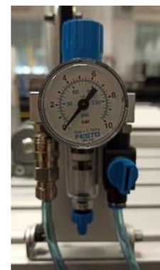
Figura 20. Válvula de vacío para pinza Festo.
