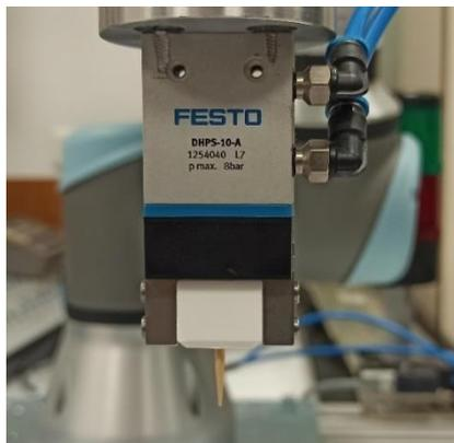
Figura 82. Detalle pieza para medir puntos del tablero.
