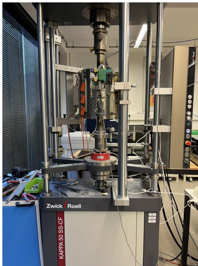
Obrázek 32: Trhací stroj Zwick Roell KAPPA 50 SS-CF
