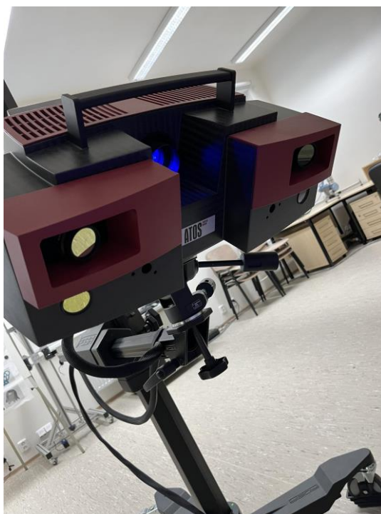
Obrázek 55: Bezkontaktní skener Atos III Triple Scan
